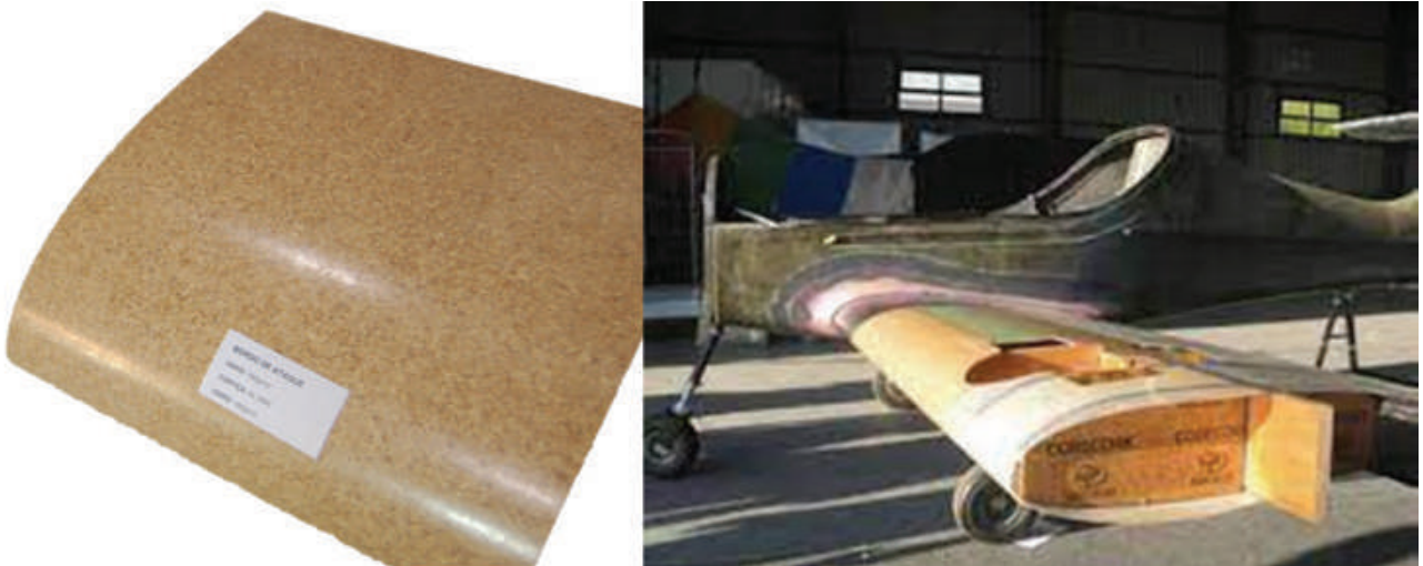
Şekil 3. Mantar kompozitlerden üretilen hücum kenarı ve kanat kaburga yapıları [3]
